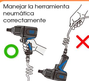
Manejar la herramienta neumática correctamente
