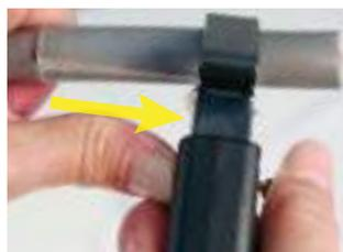
Retirar las vainas del cable sin dañar los cables internos
