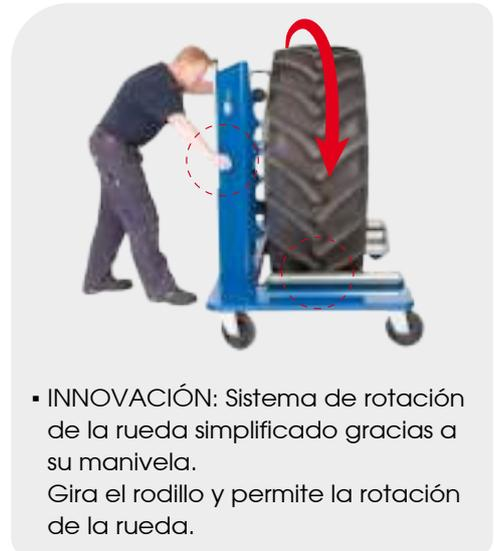
• INNOVACIÓN: Sistema de rotación de la rueda simplificado gracias a su manivela. Gira el rodillo y permite la rotación de la rueda.
